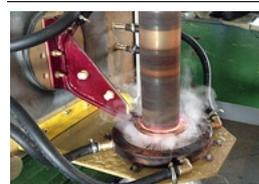
Комплект индукторов предназначен для нагрева токами высокой частоты разнообразных по форме изделий.
