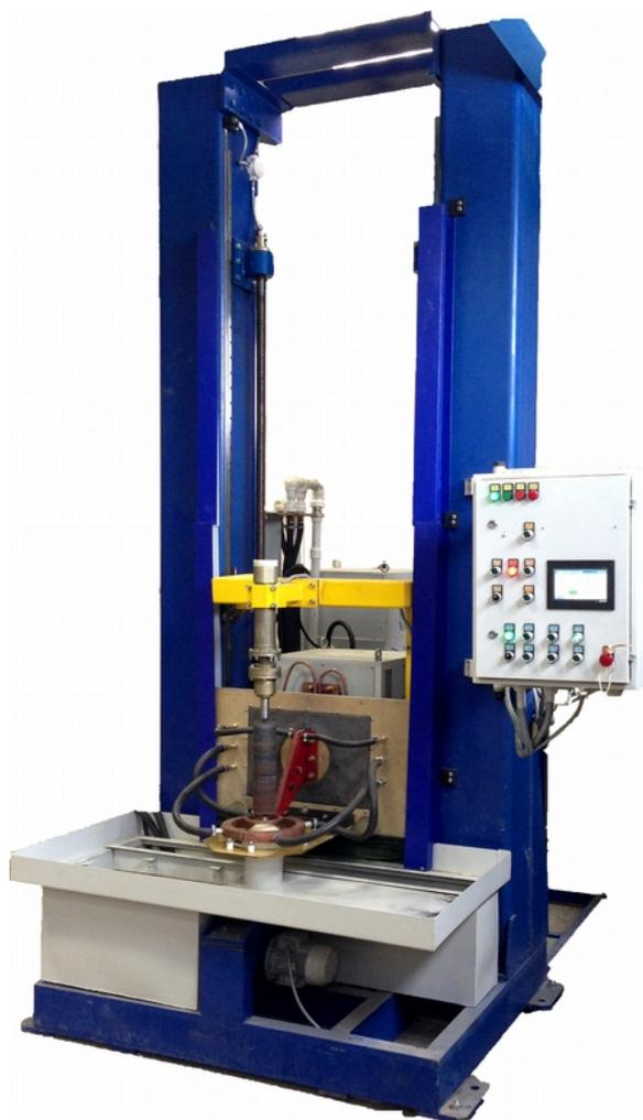
Станок закалочный СЗВ представляет собой универсальный станок для вертикальной закалки непрерывно-последовательным способом тел вращения (валов, втулок, колец, колес, шестерён с малым модулем). Являясь современным решением в области индукционного нагрева, станок обеспечивает высокую производительность, повторяемость результатов и постоянную готовность к работе.
